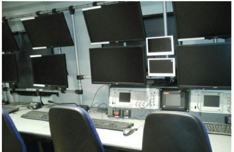
Paneles de control de la nueva máquina registradora de vía
